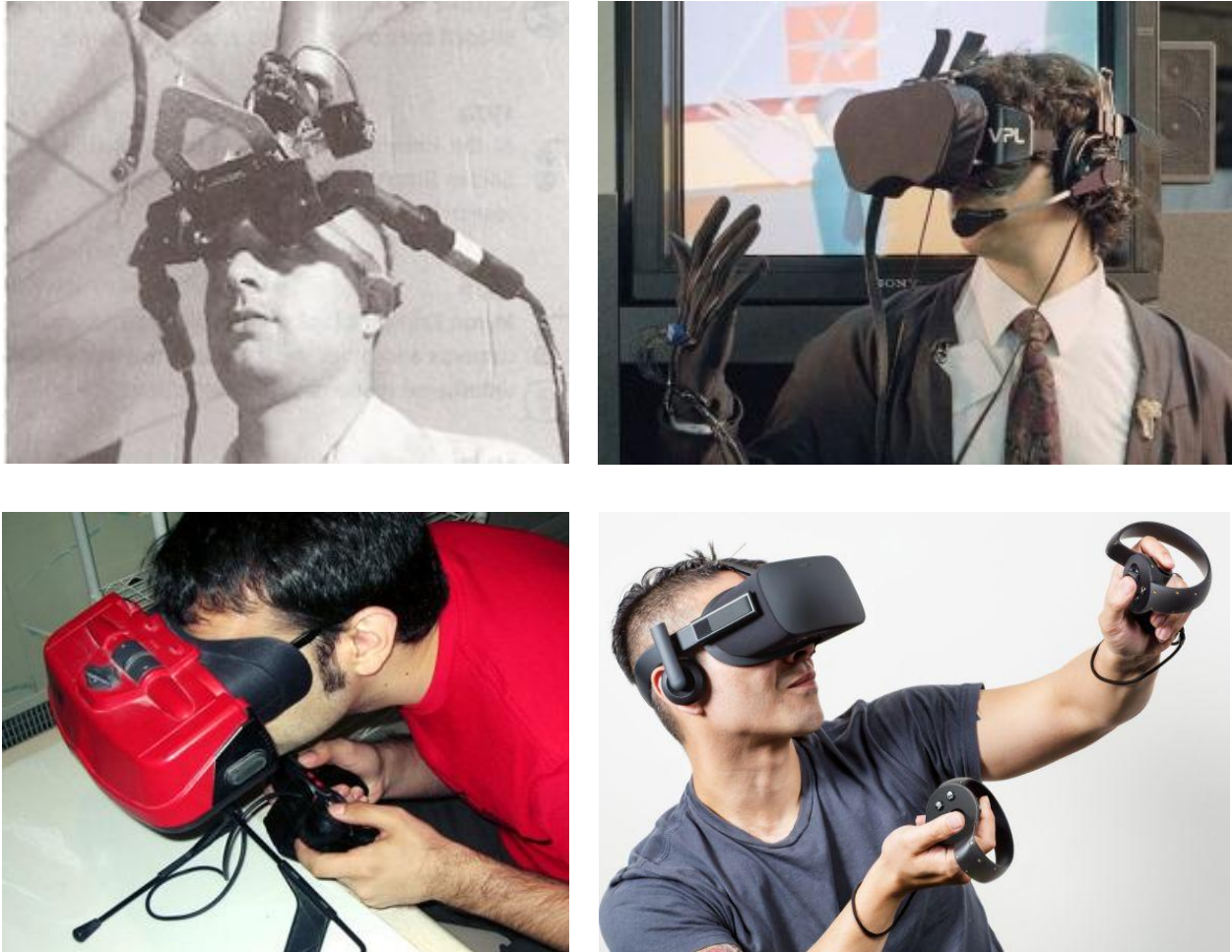
Slika 37. Razvoj VR tehnologije: početak tehnologije – ‘Damoklov mač’ sistem Ivana Suterlenda iz 1968. godine (gore levo); prvi komercijalni VR sistem - Eye Phone 1 iz 1989. godine (gore desno); pokušaj da se virtualna realnost učini dostupna široj javnosti - Nintendo VirtualBoy iz 1994. godine (dole levo); prvi uspešno masovno proizvedeni sistem za VR iz 2016. godine - Oculus Rift, Facebook (dole desno)
