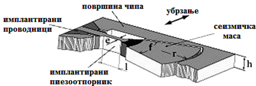
Слика 3.8. Пиезоотпорни MEMS акцелерометар осетљив на убрзање у равни акцелерометра са пиезоотпорником имплантираним у бочне стране танке греде. [51]
