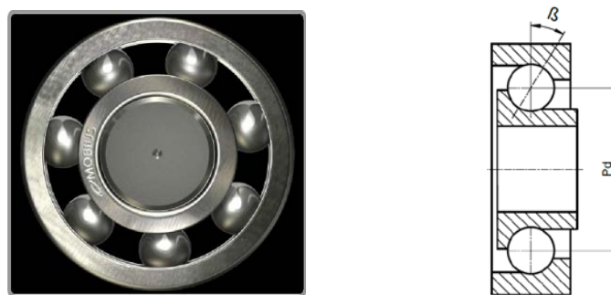
Слика 3.31. Структура и геометрија котрљајућег лежаја. [125]
