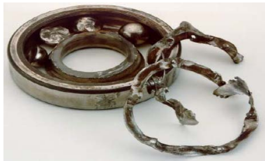
Слика 3.23. Примери катастрофалних кварова: а) потпуно уништен генератор; б) уништен куглични лежај.
