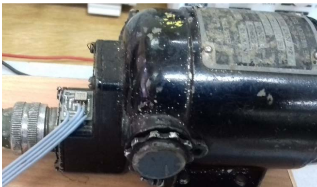
Слика 4.5. Мерни систем за мерење вибрација електромотора (лево) и плочица са акцелерометром (десно).
