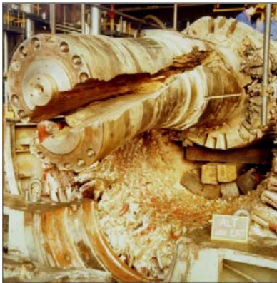
Слика 3.23. Примери катастрофалних кварова: а) потпуно уништен генератор; б) уништен куглични лежај.
