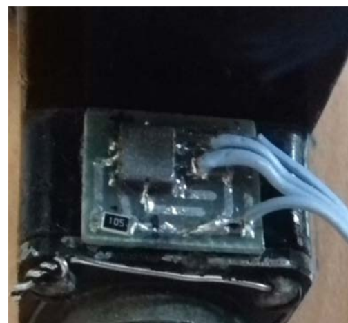
Слика 4.5. Мерни систем за мерење вибрација електромотора (лево) и плочица са акцелерометром (десно).
