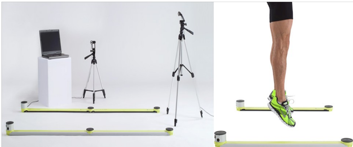
Слика 1 - Ортојумп- оптички систем за мерење
