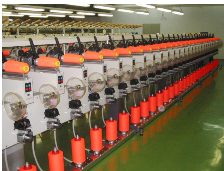
Slika 2.5. Proces završne obrade i premotavanja
