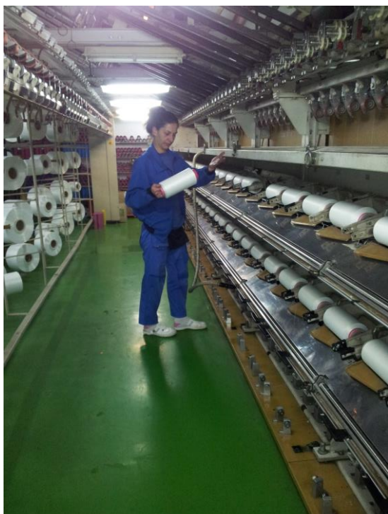
Slika 2.3. Proces teksturiranja POY multifilamenta na mašini FTF-15
