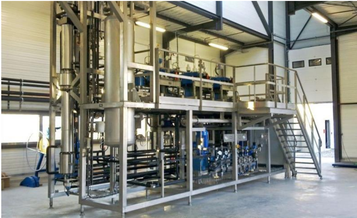
Slika 22. Industrijsko postrojenje za SFE (Separex, Francuska)
