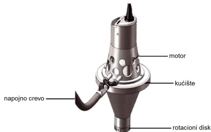
Slika 25. Rotacioni atomizer
