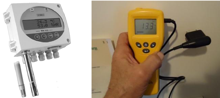
Slika 4.2 Instrumenti za merenje: a) vlage u konstrukciji i b) relativne vlažnosti
