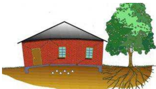
Slika 5.6 Uticaj vegetacije na deformaciju i oštećenje temelja
