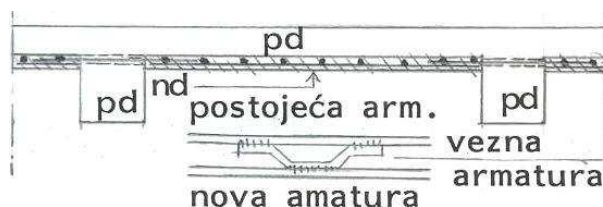
Slika 5.51 Ojačanje ploče izradom novog AB sloja sa donje strane
