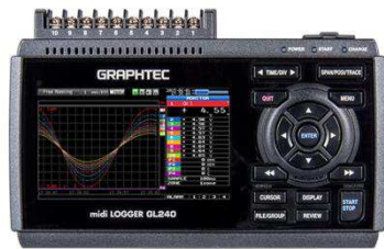
Slika 4.8 Mali logeri sa integrisanim senzorima za merenje temperature, pritiska, vlažnosti, osvetljenja [en.wikipedia.org, preuzeto 04.2016.]
