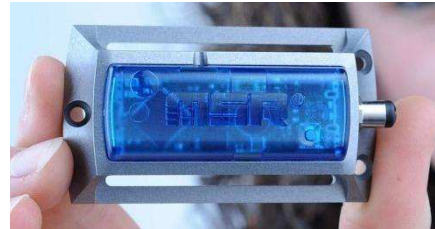
Slika 4.8 Mali logeri sa integrisanim senzorima za merenje temperature, pritiska, vlažnosti, osvetljenja [en.wikipedia.org, preuzeto 04.2016.]
