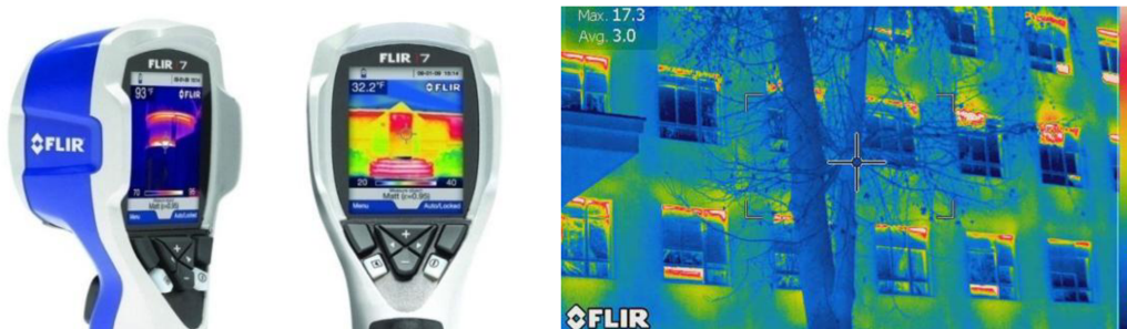
Slika 4.7 Izgled i prikaz snimka savremene IC termografske kamere [www.energovizija.si, preuzeto 04.2016.]
