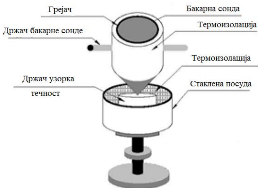
Слика 4.5 Шема апаратуре методе термичког компаратора [99]
