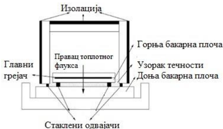
Слика 4.2 - Шема апаратуре за стационарну мерну методу са паралелним плочама [95]
