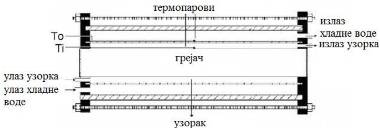
Слика 4.3 - Шема апаратуре за методу са цилиндричном ћелијом [96]
