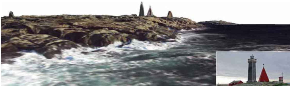
Слика 95. DTM урађен на основу LIDAR података -резолуција 25 cm по пикелу (Porthe, 2006)
