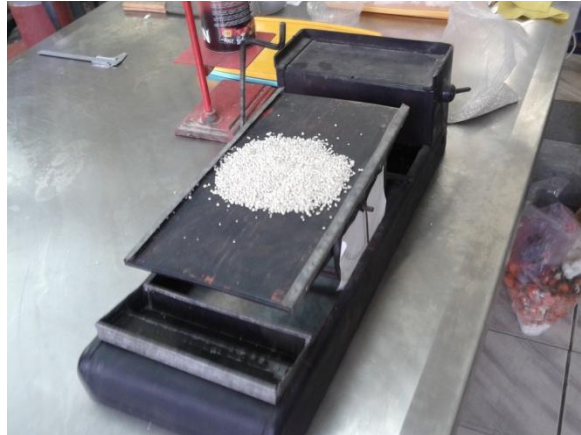
Sl. 8 Strma ravan za određivanje statičkog ugla trenja
