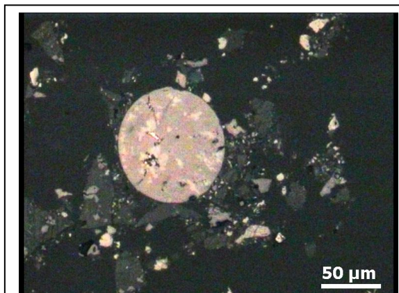
Slika 23. Kružni presek kompleksnog sulfida sistema Cu-Fe-S. Odbijena svetlost, vazduh, II N
