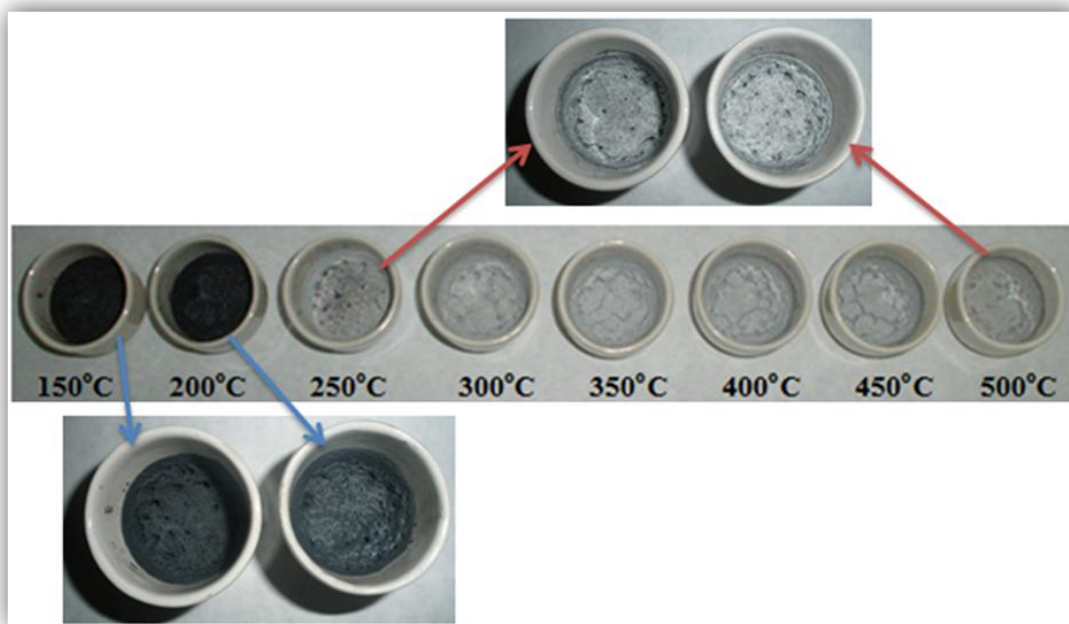
Slika 56. Izgled (boja) prženaca dobijenih jednočasovnim prženjem u temperaturnom intervalu 150 - 500^{\circ}\text{C}
