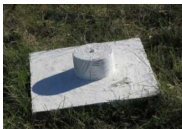
Slika 3.8.4.5. Tačka državne referentne GPS mreže
