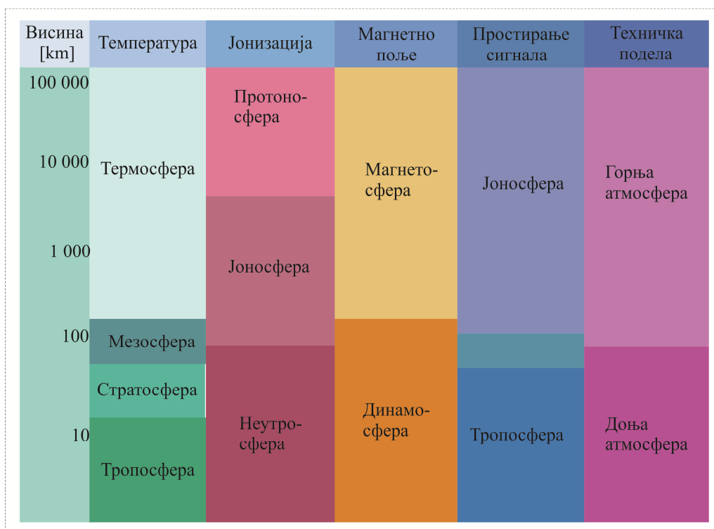
Слика 2.4: Могућа шема поделе Земљине атмосфере (Seeber, 2003, Satellite Geodesy)
