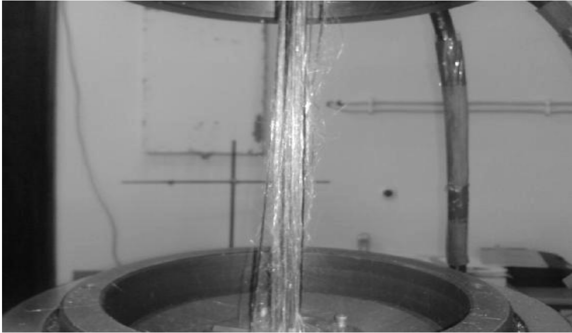
Слика 27. Деламинација при експерименталном кидању композитног материјала прве производне серије композитних шипки
