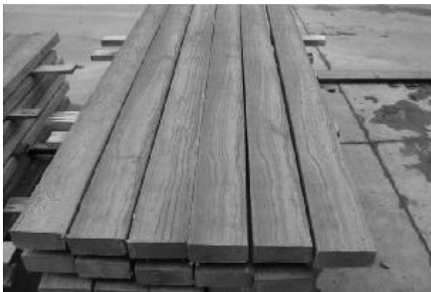
Слика 74. Префабриковани елемент оградe погодан за армирање композитом 48
