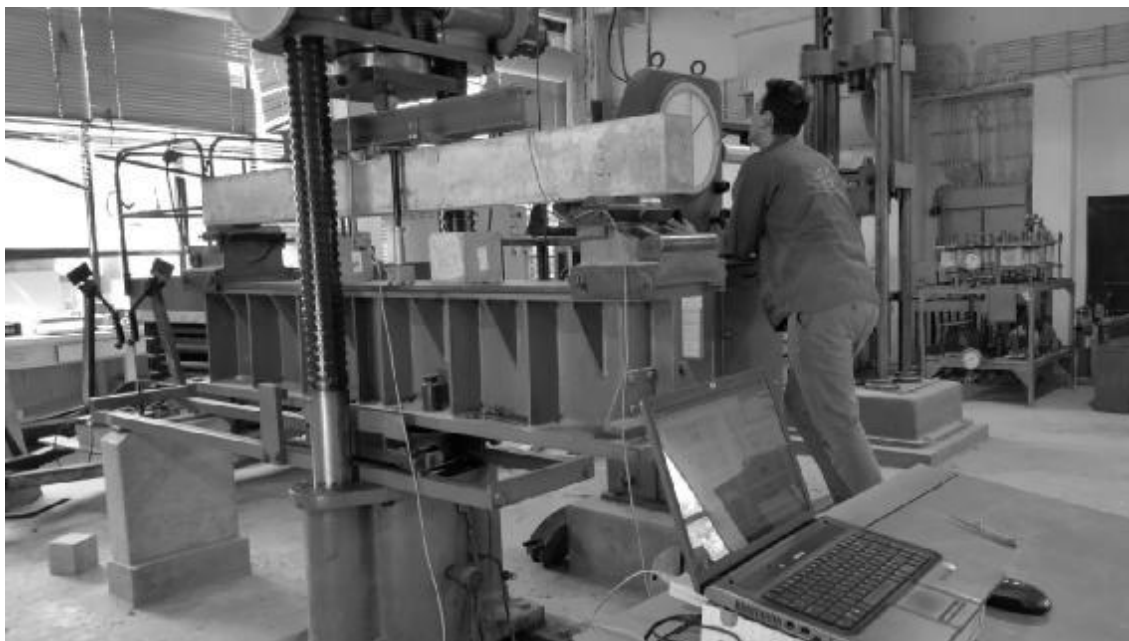
Слика 44. Почетак наношења силе на узорку са ознаком 3
