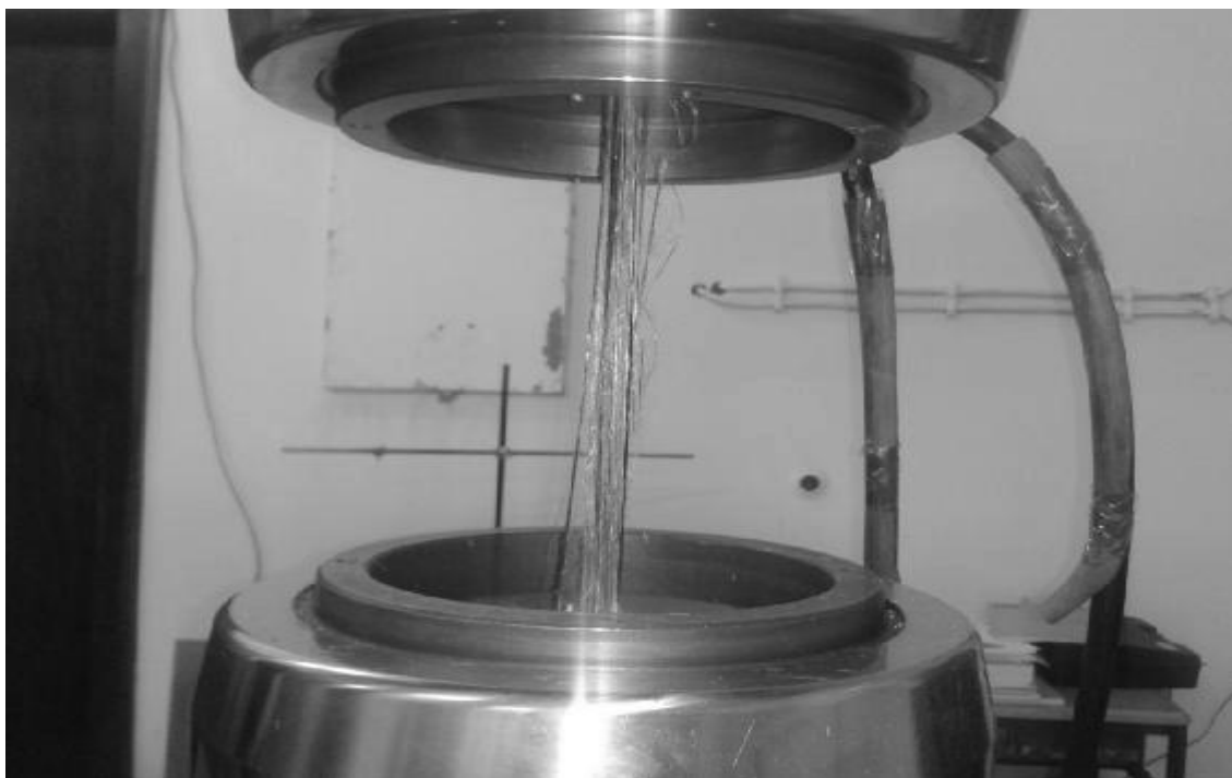
Слика 26. Експериментално кидање материјала из прве производне серије композитних шипки
