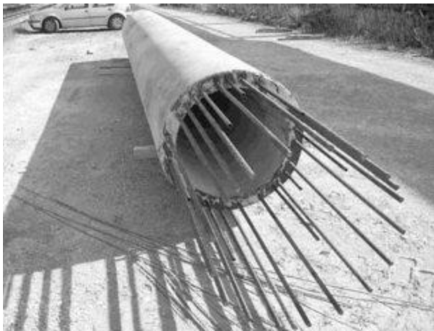
Слика 76. Инсталациона цев као елемент погодан за армирање композитом 50
