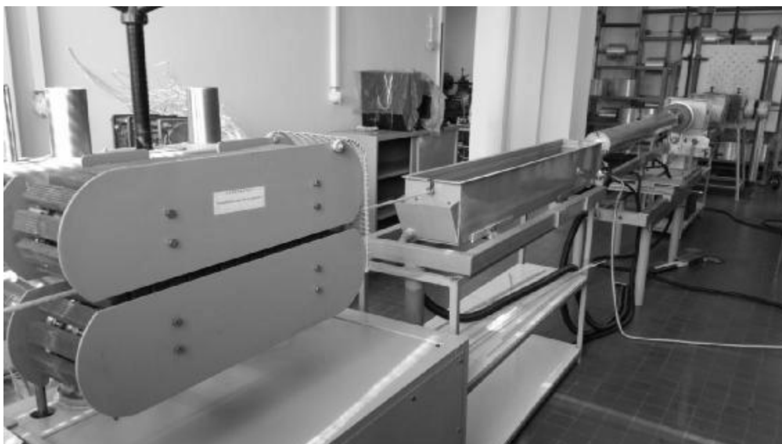
Слика 21. Производна линија - процес пултрузије
