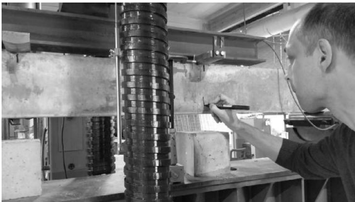
Слика 48. Формирање и означавање прве прслине на узорку са ознаком 1
