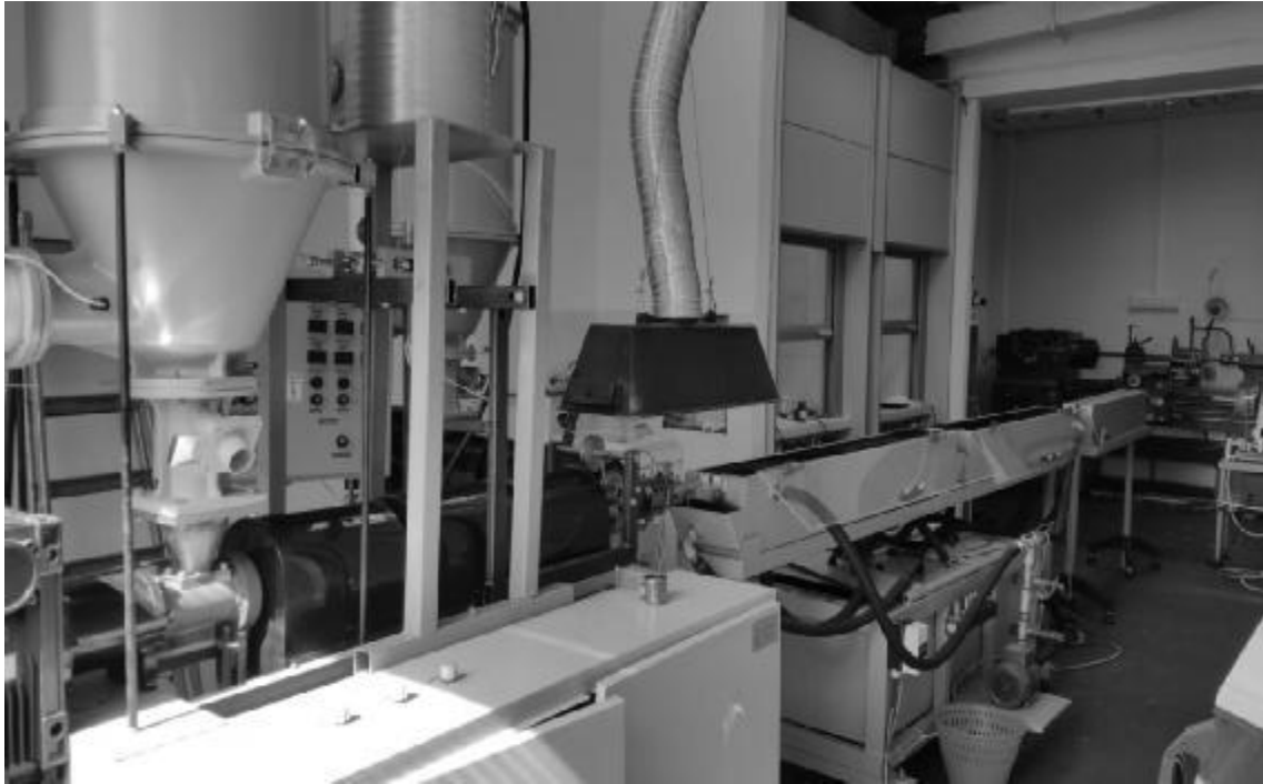
Слика 17. Екстудер који се користи за наношење ПЕТ-а на стаклена влакна
