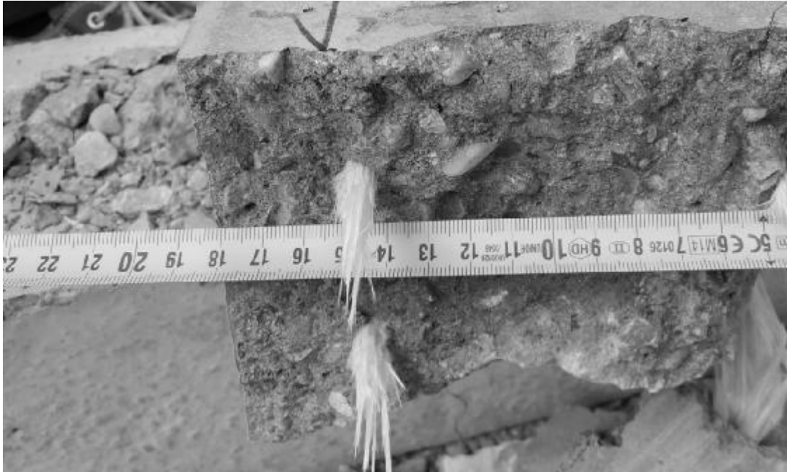
Слика 52. Излед пресека након лома са деламираним композитном арматуром - узорак са ознаком 1
