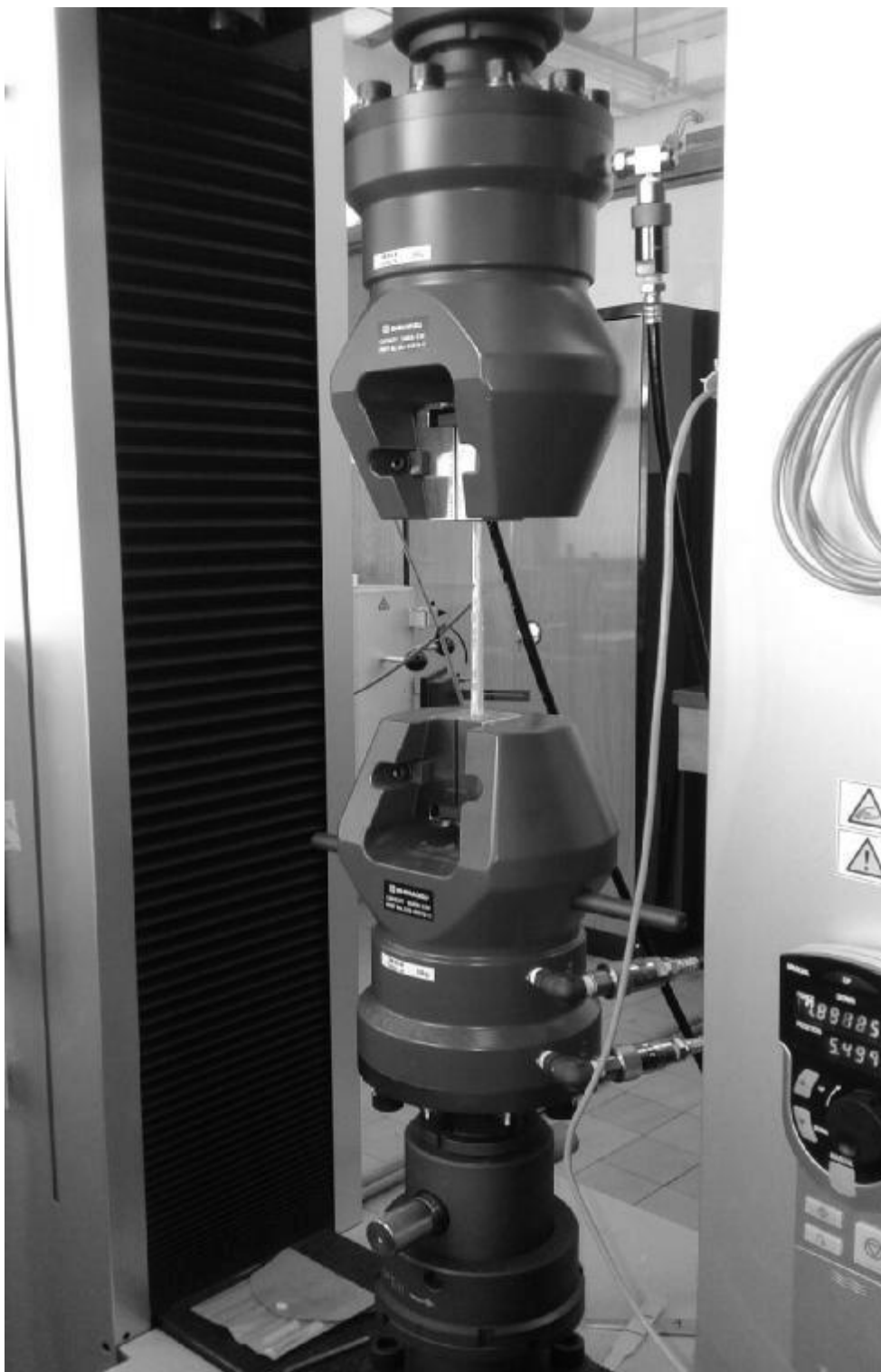
Слика 29. Експериментално кидање композитног материјала из друге производне серије композитних шипки
