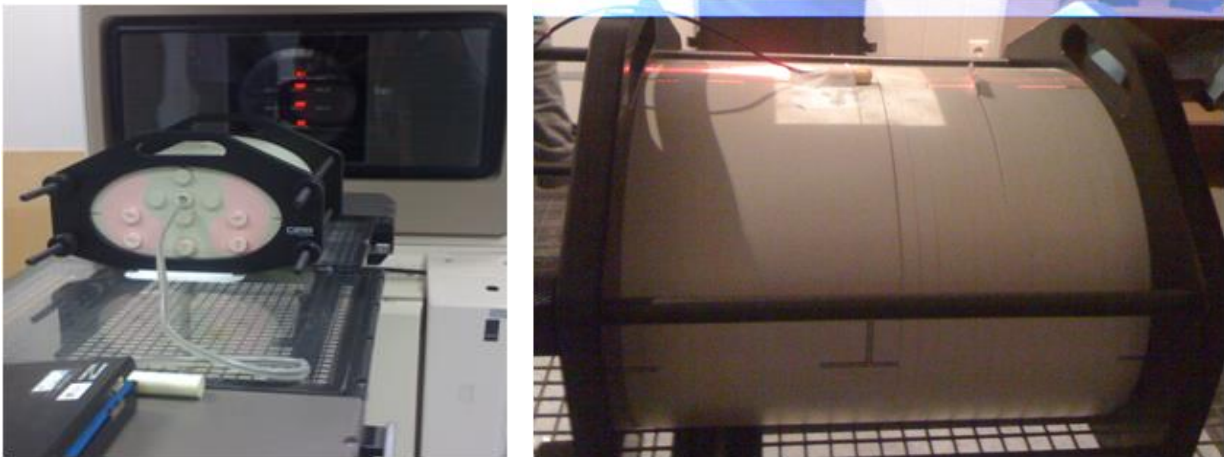
Slika 30. Prikaz postavke za merenje za verifikaciju in vivo dozimetrije pomoću CIRS toraks fantoma
