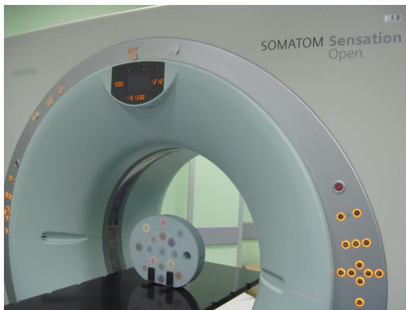
Slika 10. Postavka CIRS fantoma 062M na CT skeneru
