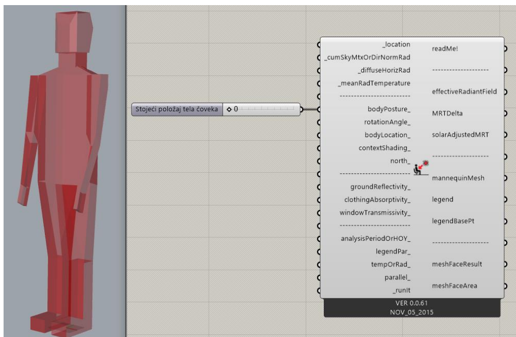
Slika 10. Stojeći položaj modela čoveka prikazan u Rhinoceros-u (levo) i odabrana vrednost 0 za Body Posture u komponenti Outdoor Solar Temperature Adjustor Ladybug-a (desno). (Ivana Bajšanski)
