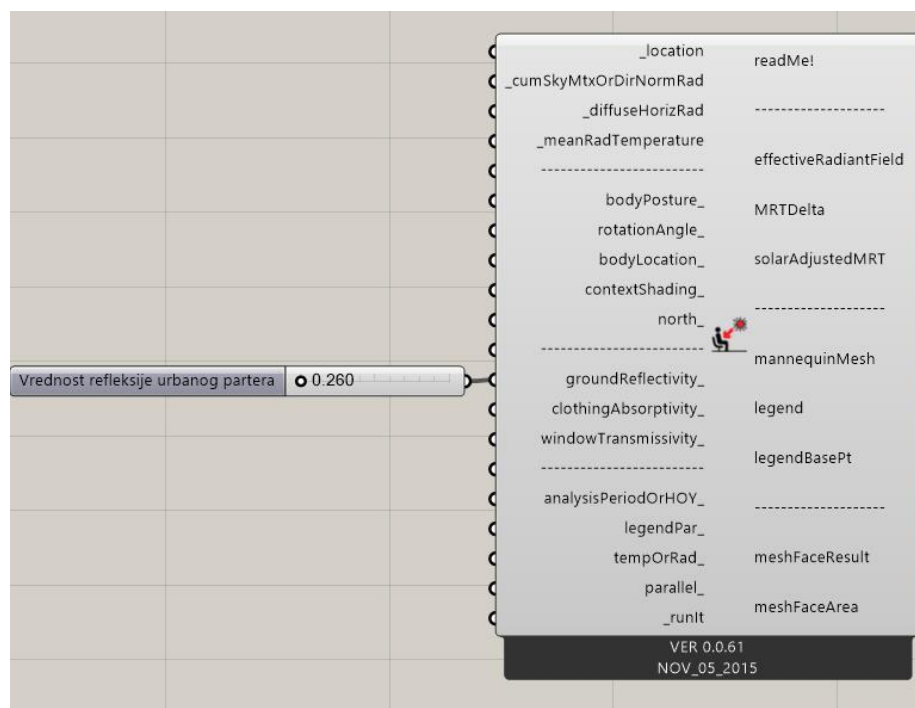
Slika 18. Podešena vrednost refleksije partera od 0.26 u komponenti Outdoor Solar Temperature Adjustor Ladybug-a. (Ivana Bajšanski)
