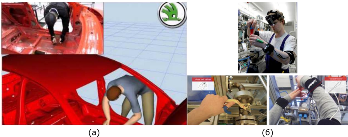
Слика 4-1. (а) Комбинација Synertial IGS одела и Siemens JACK софтвера за ергономску процену на позицијама монтаже делова у возилима, истраживање које се спровело у фабрици произвођача Шкода (Преузето са: www.synertial.com ); (б) – мрежа ИМУ сенора развијена током пројекта Cognito . У овом случају, поред могућности праћења радникових покрета, Cognito систем пружа могућност подршке радника у смислу пружања информација преко мини дисплеја који је монтиран на главу радника (Преузео са: http://www.ict-cognito.org )
