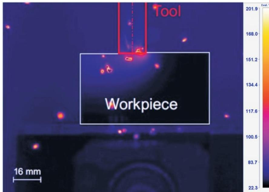
Slika 2.7: Termogram dobijen tokom obrade glodanja legure magnezijuma AZ91HP (Zgorniak i Grdulska, 2012)
