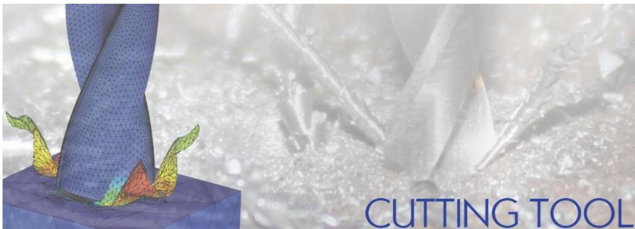
Slika 3.13: Uporedni prikaz simulacije procesa bušenja u *Third Wave AdvantEdge*-u i realnog stanja
