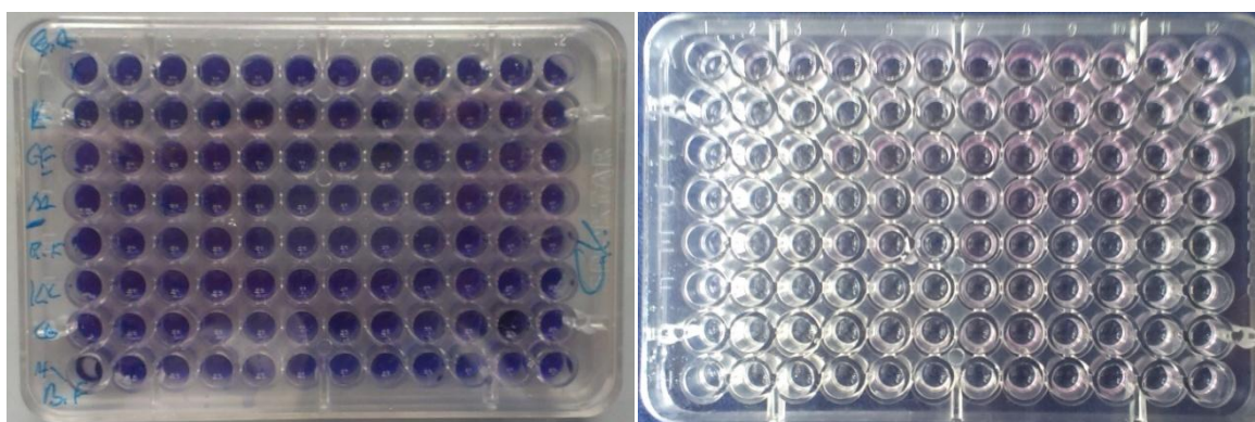
Slika 12. Fotografije ispitivanja MIC biofilma tokom bojenja i nakon ispiranja
