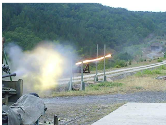
Слика 30а,б Стабилност сагоревања пиротехничког пуњења јединице ГГ на бази магнезијума и 2,6 g M4 припалне смеше
