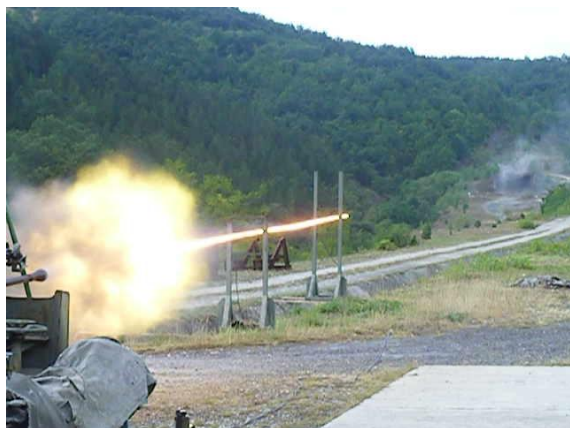
Слика 29а,б Стабилност сагоревања пиротехничког пуњења јединице ГГ на бази магнезијума и 2,6 g M4 припалне смеше
