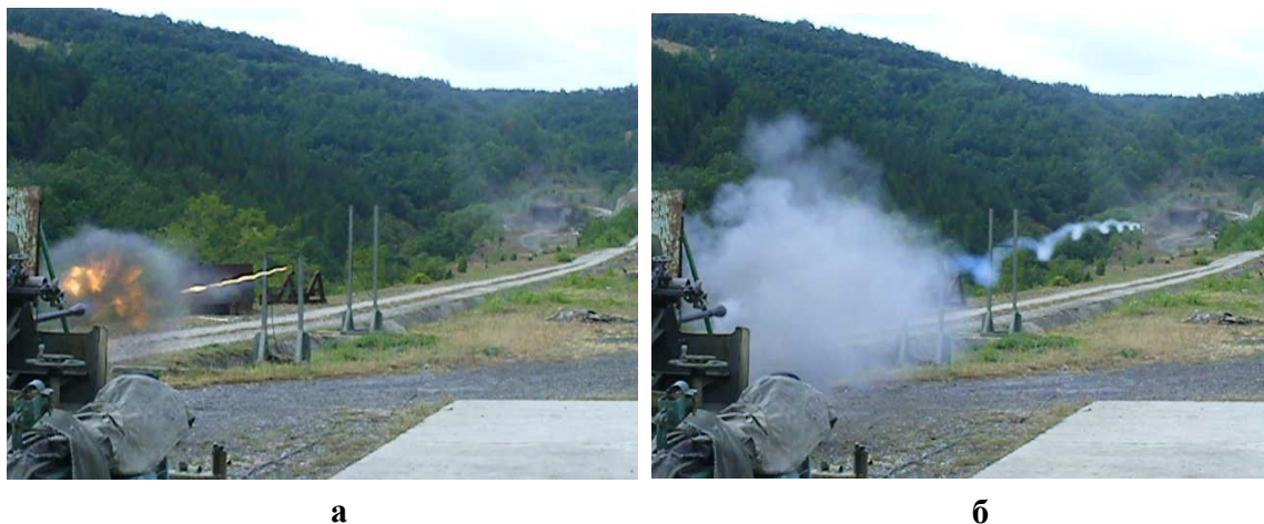
Слика 27а,б Стабилност сагоревања пиротехничког пуњења јединице ГГ на бази лактозе и 4 g M4 припалне смеше
