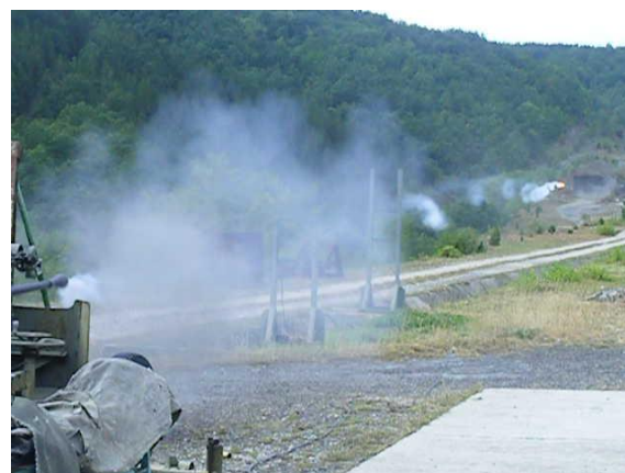
Слика 30а,б Стабилност сагоревања пиротехничког пуњења јединице ГГ на бази магнезијума и 2,6 g M4 припалне смеше
