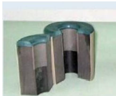
Слика 3. Попречни пресеци пуњења ГГ неких артиљеријских система
