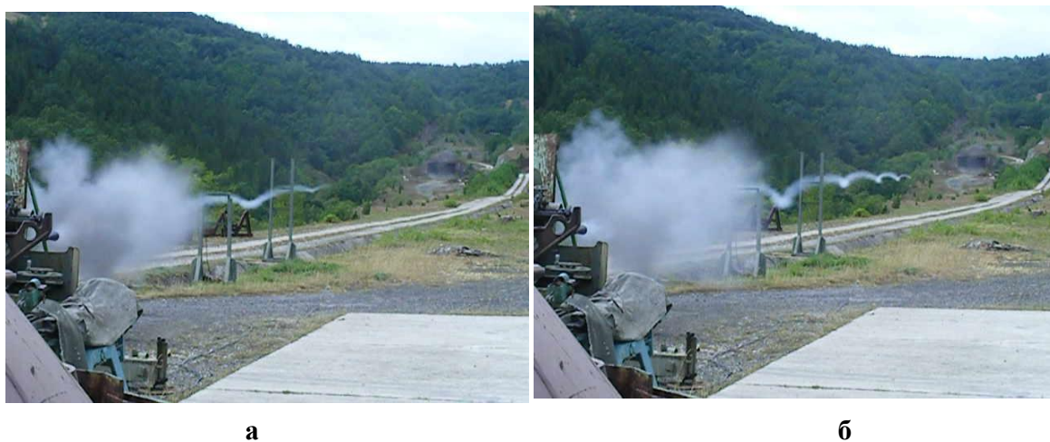
Слика 28а,б Стабилност сагоревања пиротехничког пуњења јединице ГГ на бази лактозе и 2 g M4 припалне смеше
