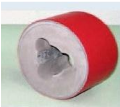
Слика 3. Попречни пресеци пуњења ГГ неких артиљеријских система
