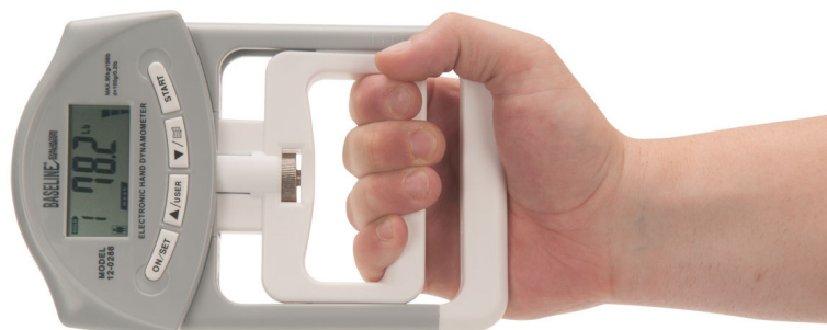
Slika 4-1 Elektronski ručni dinamometar marke Baseline Electronic Smedly Hand Dynamometer 200 lb. W54654 , prilikom merenja jačina stiska šake
