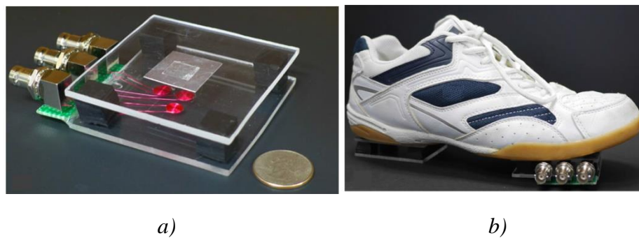
Slika 2.20 Fotografije a) realizovanog prototipa senzora i b) patika sa ugrađenim prototipom senzora, [62]
