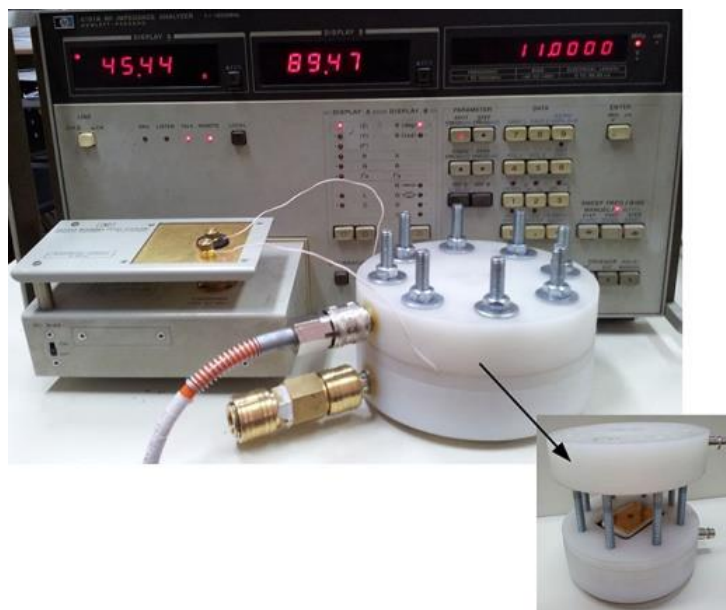
Slika 5.15 Mjerna postavka i upakovan senzor moniran i fiksiran u komori držača
