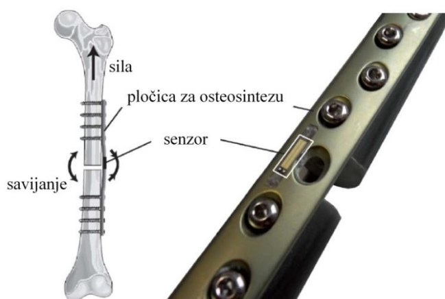
Slika 2.17 Bežični magnetnostriktivni senzor za primjenu u osteosintezi, [61]
