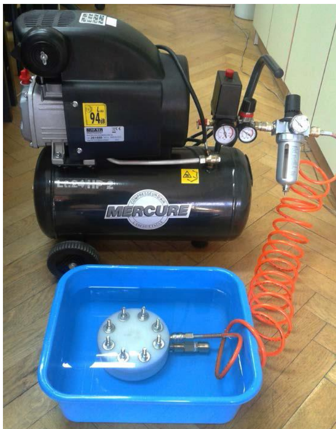
Slika 5.4 Postavka za testiranje držača senzora pod vodom
