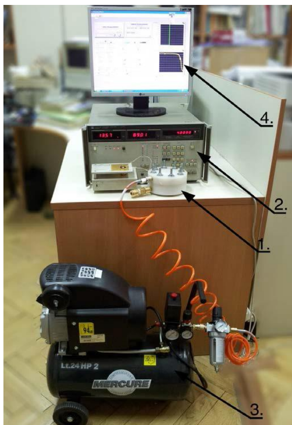
Slika 5.5 Mjerna postavka za testiranje senzora pritiska
