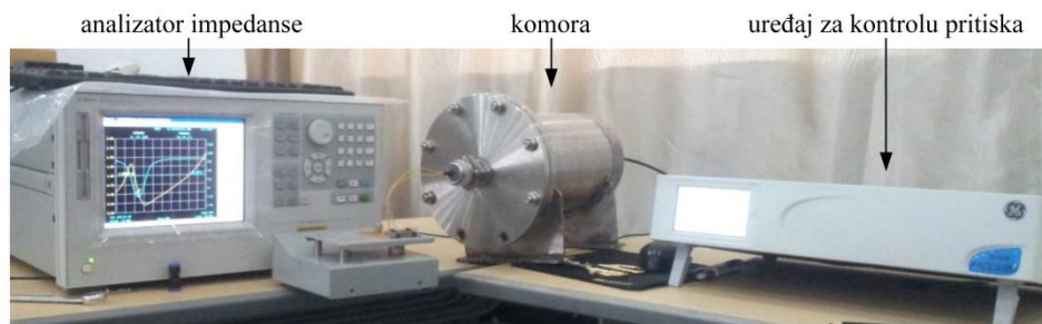
Slika 2.25 Mjerni sistem za testiranje senzora pritiska, [23]
