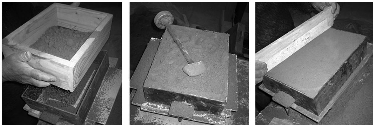
Сл. 37 Процес формирања калупа од песка за ливење
