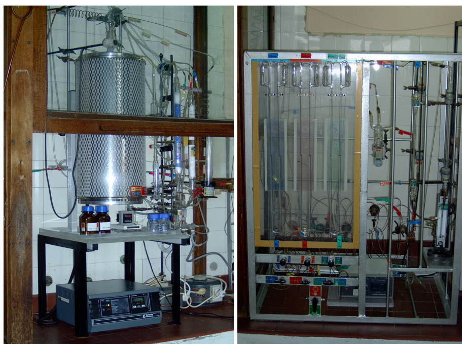
Slika 12. Fotografije aparature za redukciju: levo - peć sa kontrolnom jedinicom brzine grejanja; desno - podstanica sa mešačem za kontrolu vrste gasova i njihovih protoka
