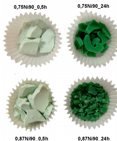
Slika 17. Prekursori 0,75Ni90 i 0,87Ni90 koji su starili 0,5h (levo) i 24h (desno)
