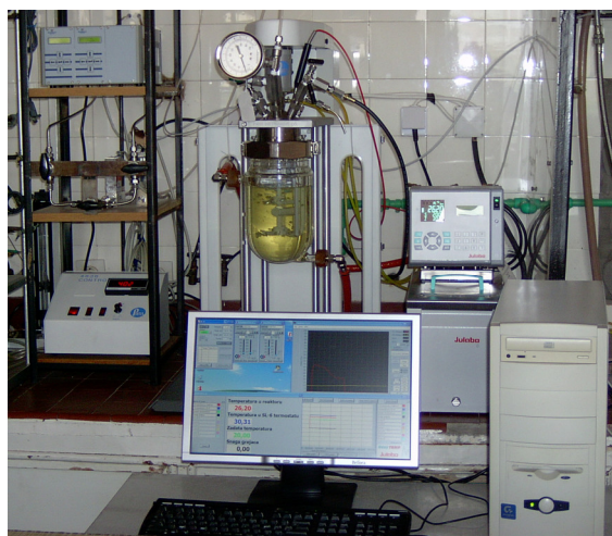
Slika 13. Fotografija reaktorskog sistema za hidrogenizaciju biljnih ulja
