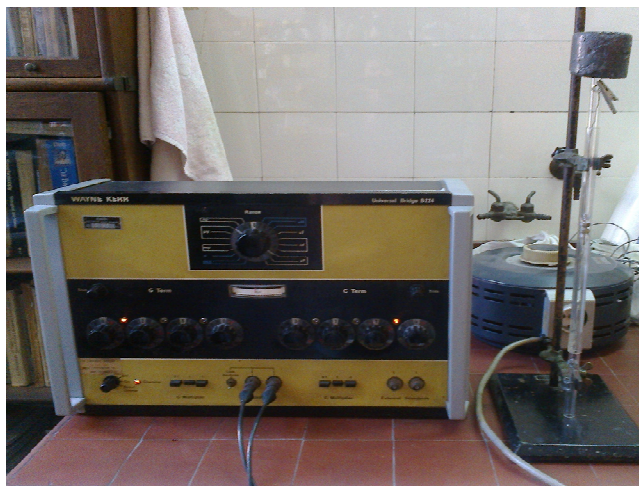
Slika 23. Slika uređaja Wayne Kerr Universal Bridge B224.
