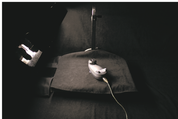
Slika 5.19. Pozicija spektrofotometra pri merenju upadnog zračenja (na slici je prikazan slučaj kada su prilikom merenja korišćene fluorescentne lampe)
