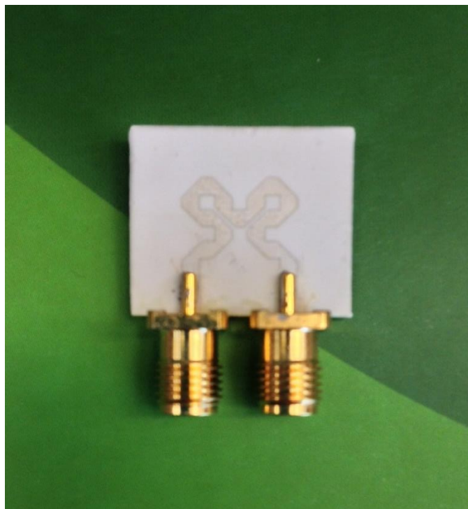
Slika 8.12: Fabrikovani senzorski element sa postavljenim SMA konektorima
