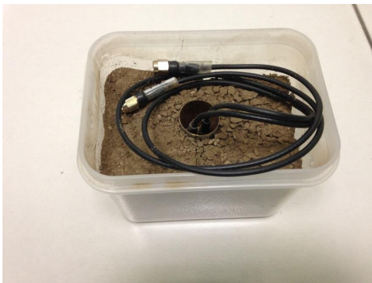
Slika 8.15: Uzorak zemljišta sa postavljenom mernom sondom
