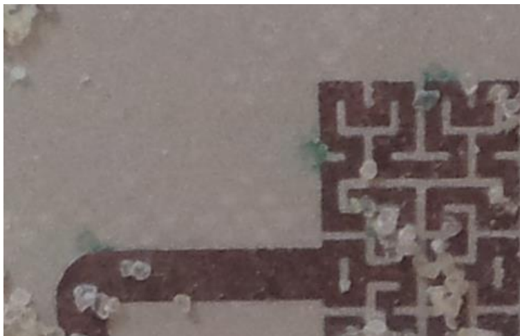
Slika 6.9: Promene na bakru senzorskog elementa pod uticajem korozije
