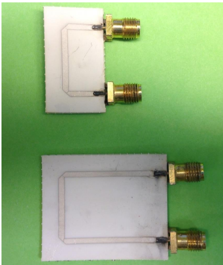
Slika 8.3: Mikrostrip linije za električnu karakterizaciju Ceramtec GC trake i granularne matrice
