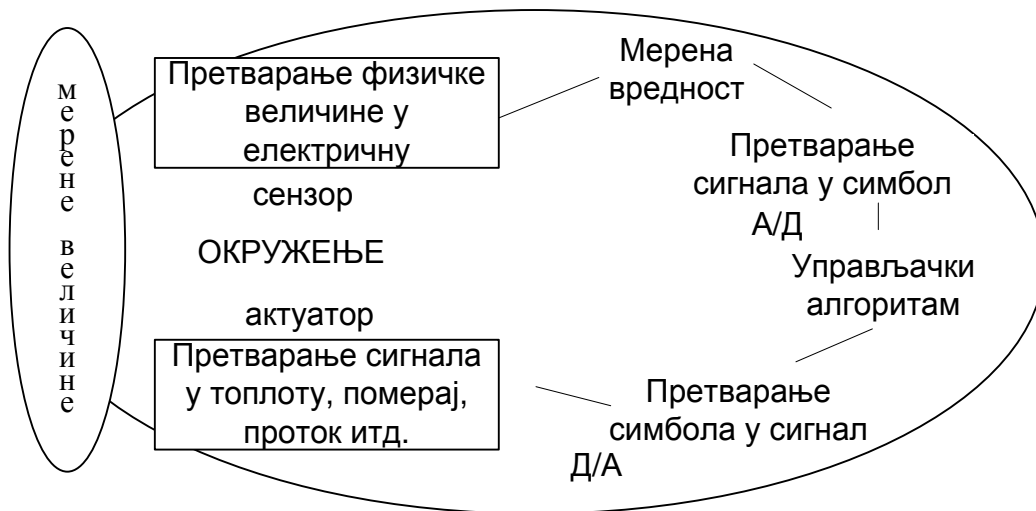
Слика 2.1 Општа блок шема система за мерење и управљање процесом
