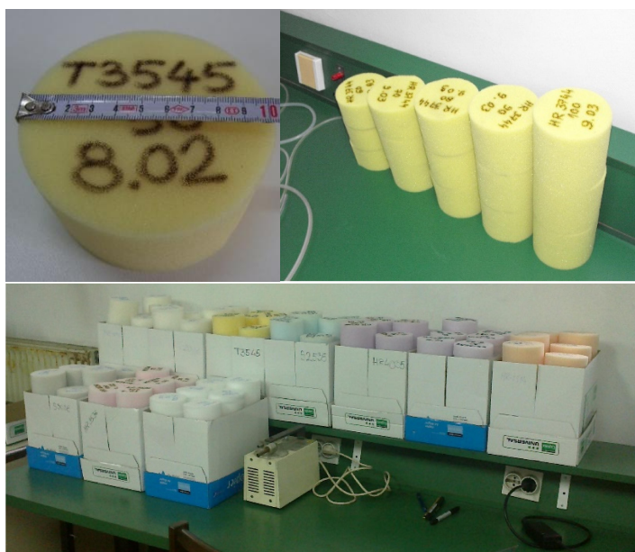
Слика 3.18. Узорци од полиуретанске пене
