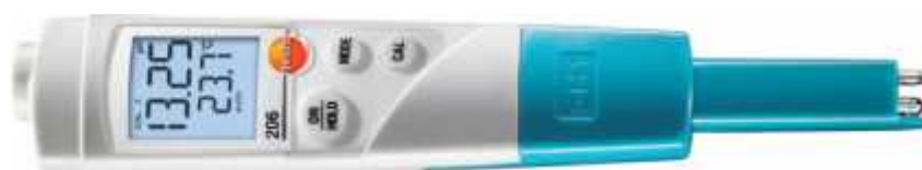
Слика 34. Инструмент за одређивање рН вредности основног премаза
