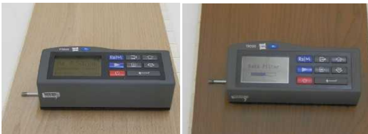
Слика 28. Мерење параметра храпавости Ra на обрušеним узорцима
