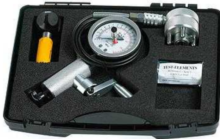
Слика 35. Инструмент за одређивање адхезије методом печатника ( Диефди инструментс )
