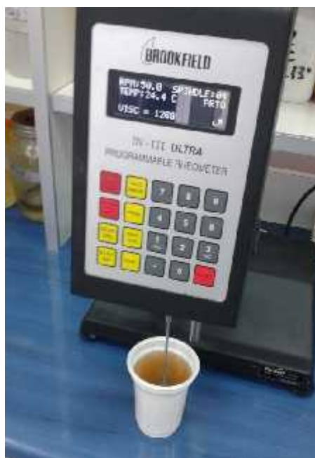
Слика 33. Мерење динамичког вискозитета на ротационом вискозиметру
