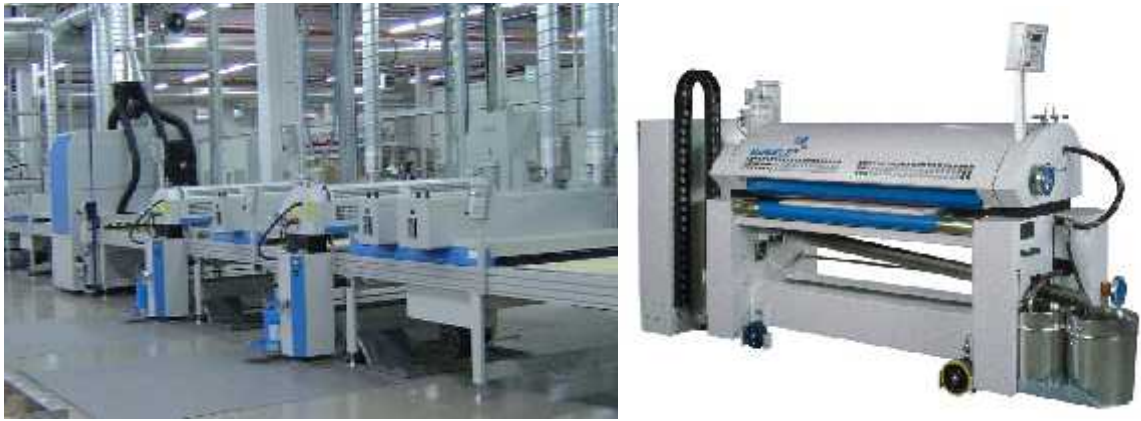
Слика 26. Изглед лакирне линије и машине за наношење УВ акрилног премаза ваљањем
