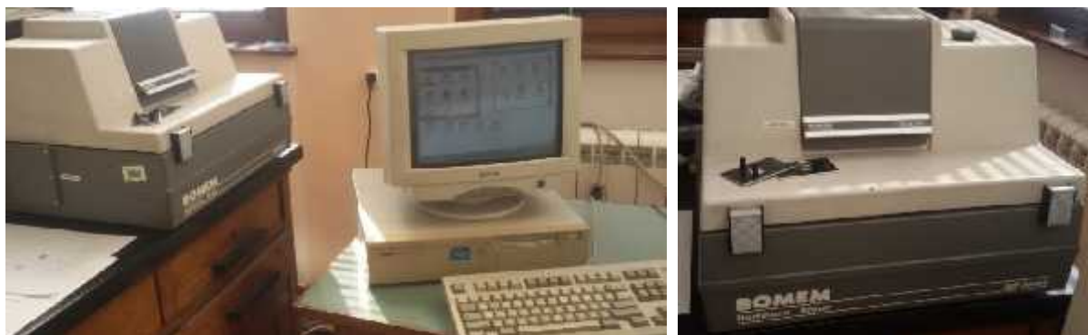
Слика 31. Изглед ФТИР спектрометра, Бомем Мишелфан, лабораторија Технолошко - металуршког факултета у Београду
