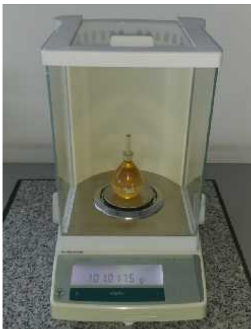
Слика 32. Мерење густине премаза помоћу пикнометра и аналитичке ваге, лабораторија „Таркет, д.о.о „ Бачка Паланка
