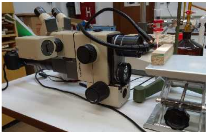
Слика 30. Изглед апаратуре за снимање контактнoг угла, Биотехнички факултет, Словенија
