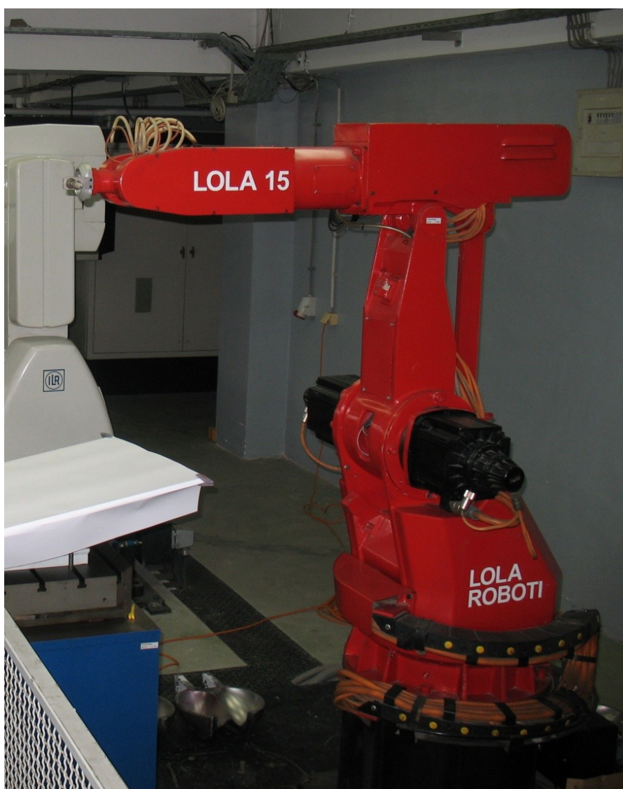
Слика 6.5 Робот вертикалне зглобне конфигурације Лола 15 са 6 степени слободе
