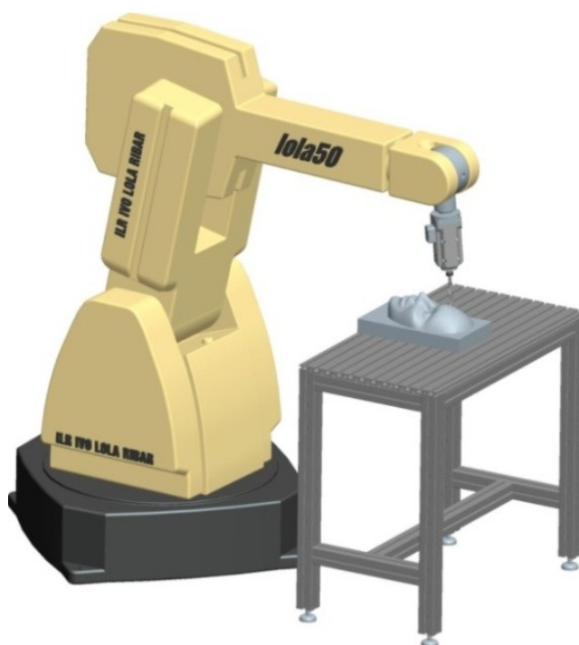
Слика 2.9 Елементарна конфигурација обрадне ћелије на бази расположивог робота вертикалне зглобне конфигурације
