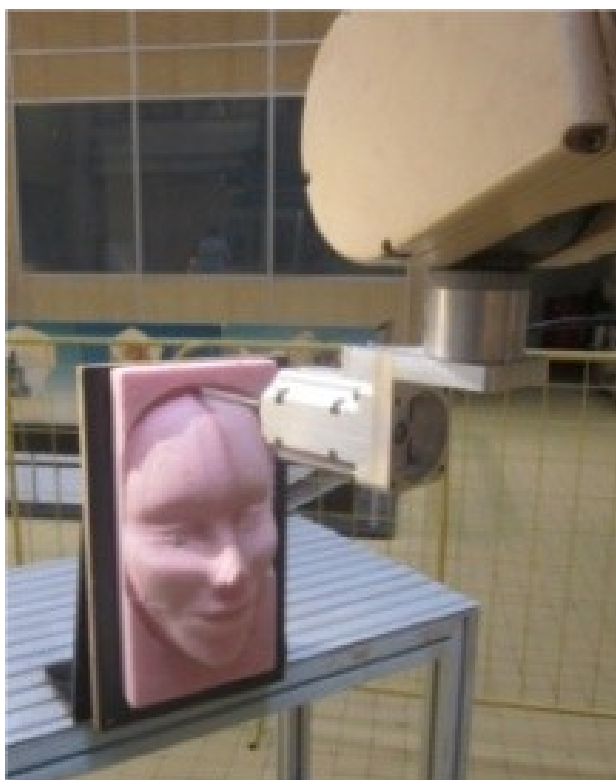
Слика 5.20. Обрада анфаса људске главе на емулираној 5-осној хоризонталној глодалици ( X, Y, Z, A, B ) у конфигурацији к3.2
