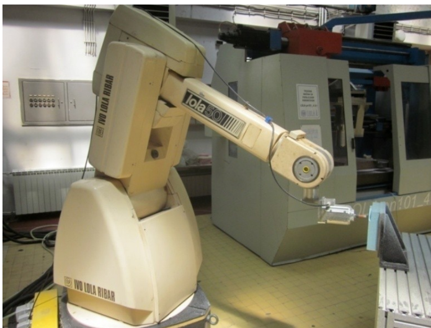
Слика 5.16. Емулација хоризонталне глодалице конфигурације (X,Y,Z,A,B)
