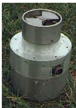
Слика 3.14. Field-mill сензор за мерења јачина електростатичких поља на великим висинама.
