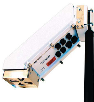
Слика 3.18. Уређај CS110 за мерење вертикалне компоненте електростатичких поља олујних облака
