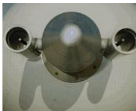
Слика 3.15. Сонде за мерење електричне проводности атмосфере
