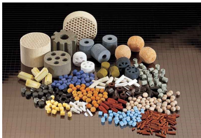
Slika 3.10 Izgled industrijskih heterogenih katalizatora
