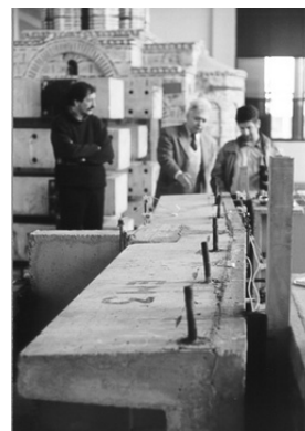
Sl. 9.2.2.5 Model EM-3: Velike deformacije veze na mestu oslanjanja
