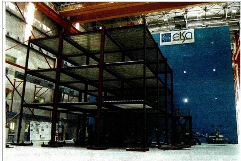
Sl. 2.16 Spregnuta (čelik betons) konstrukcija testirana pseudo-dinamički u ELSA
