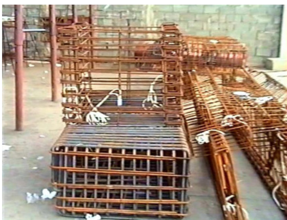
Sl. 9.9 Armatura i merne trake modela EM-5
