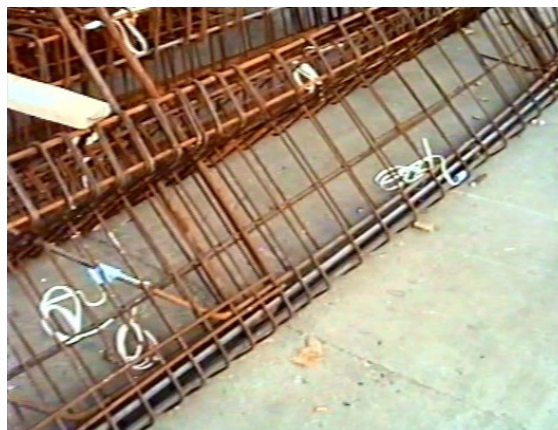
Sl. 9.10 Armatura i merne trake modela EM-7
