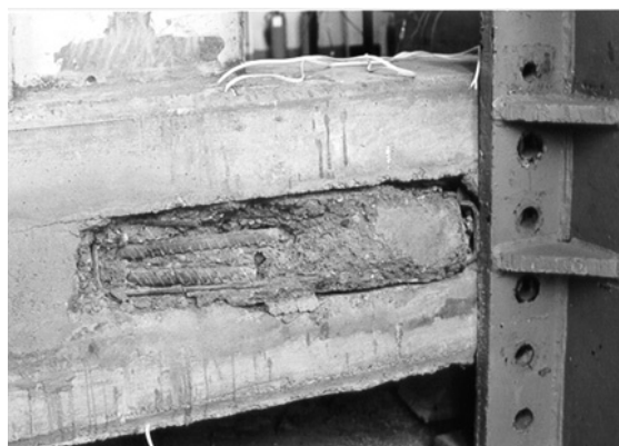
Sl. 9.2.1.5 Model EM-1: Lom veze grednog nosača sa stubom
