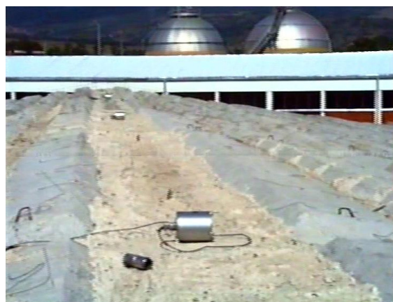
Sl. 7.8 Položaj seizmometara na krovu hale Nini
