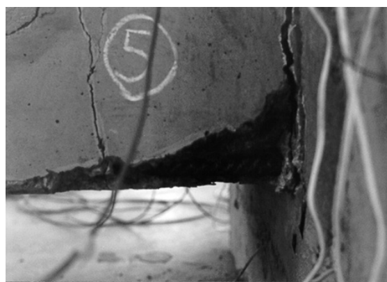
Sl. 9.2.3.5 Model EM-5: Prikaz pukotina u modelu i dela slomljenog zaštitnog sloja
