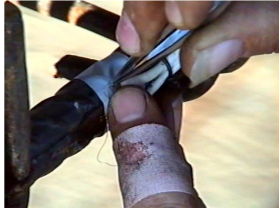
Sl. 9.2 Montaža mernih traka na armaturi modela.
