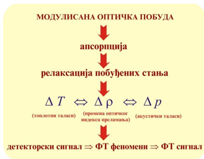
Слика 2.2. Процеси који се налазе у основи ФТ метода.
