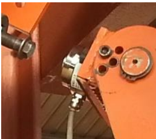
Sl.-4.87 Ugradnja dinamometra na "kolevku" (MM1)
