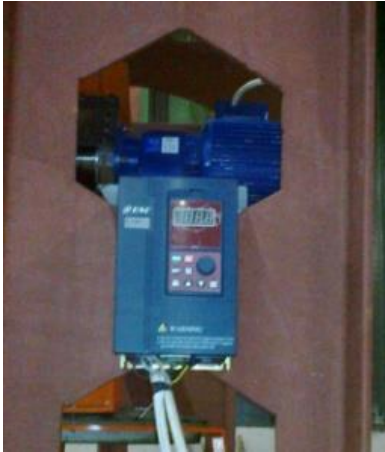
SI.-4.78 Frekventni regulator broja obrtaja elektromotora EMSIS-a [ 32 ]
