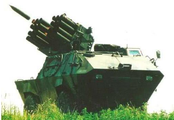
SI.-3.6 Lako oklopno vozilo LOV-RAK 24/128 mm (dva modula sa po 12 lansirnih cevi) [ 85 ]
