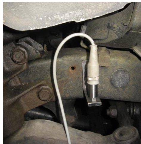
Sl.-4.88 Ugradnja davača ubrzanja na šasiju vozila (MM2)
