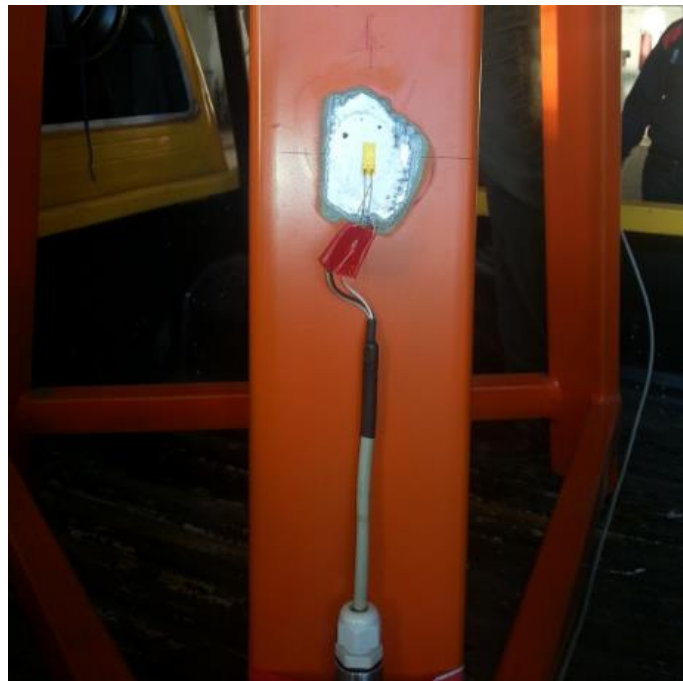
Sl.-4.95 Ugradnja merne trake na zadnji levi oslonac platforme vozila (MM7)
