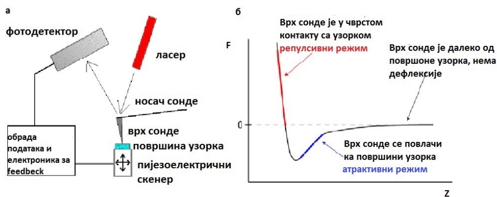
Слика 2.9.а. Принцип рада AFM -а. б. Карактеристичне криве сила-растојање које настају као последица дејства између узорка и врха AFM сонде/игле. F -сила, z -растојање сонде од узорка. преузето са http://community.nsee.us/courses/nano_experiments/AtomicForceMicroscopy/AFM%20more%20info.pdf приступљено дана 29.09.2015.
