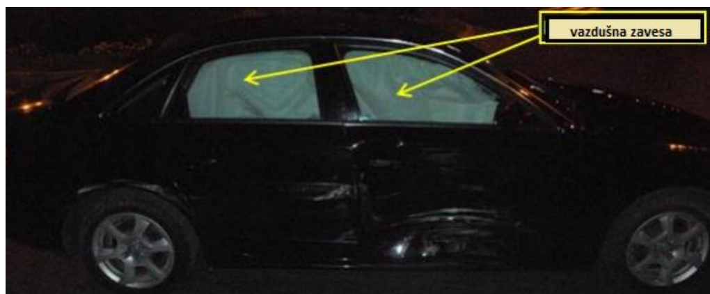
Slika 48. Oštećenja na audiju-vazдушna zavesa
