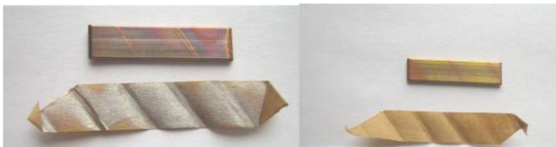
Slika 1.3.1.6 Izgled bakra i papira pre-levo i nakon dodatka 150 ppm metal pasivatora-desno ulju koje sadrži 180 mg/kg DBDS [80].
