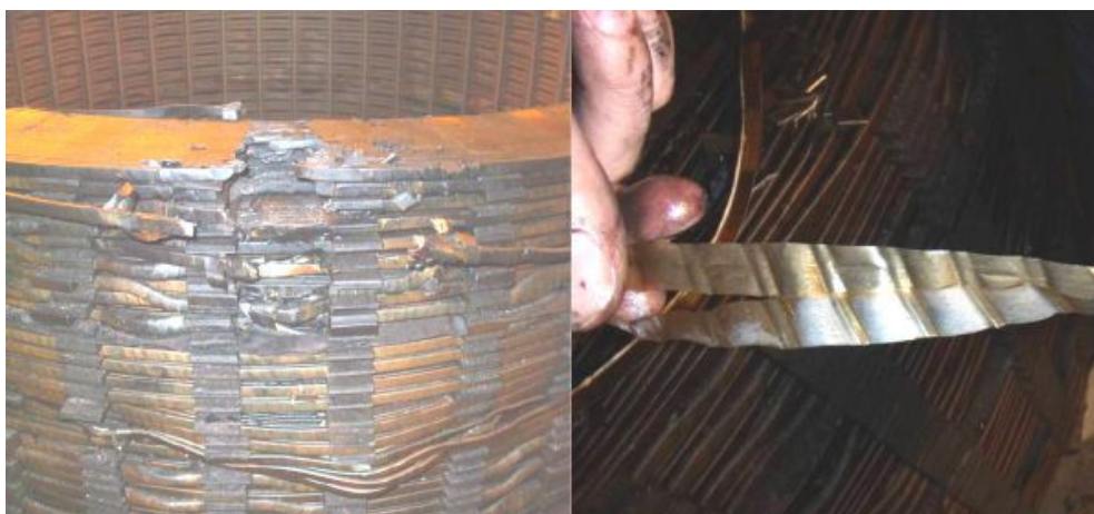
Slika 1.2.3. Mesto proboja i depoziti bakar (I) sulfida u namotaju
