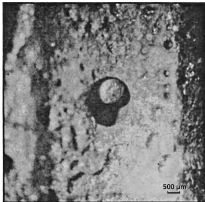
Slika 2. Mikrofotografija očvrsele šljake topljenja sulfidnog koncentrata (Mitevska, 2000)
