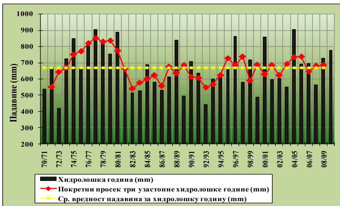
Слика 4.15.- Упоредњење кретања суме падавина за хидролошке године и кретања покретне просечне суме за три узастопне хидролошке године (1971-2010)
