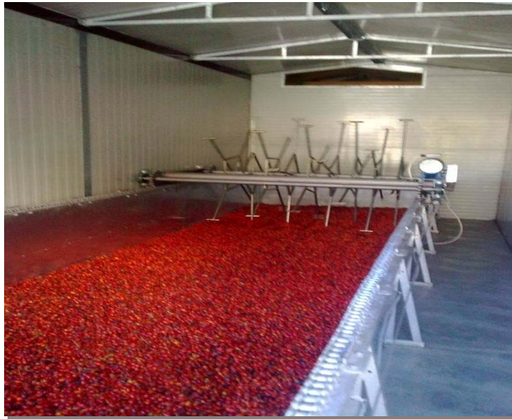
Slika 4. Podna sušara sa uređajem za mešanje
