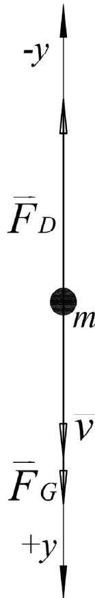
Slika 5.14 – Sile koje deluju na slobodno padajući komad stenske mase
