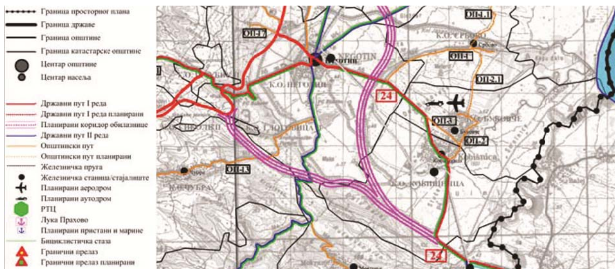
Слика VI-16. Примена визуалних варијабли за представљање квалитативних карактеристика линијских знакова на примеру карте саобраћајне инфраструктуре у Просторном плану општине Неготин (Просторни план општине Неготин, 2011)
