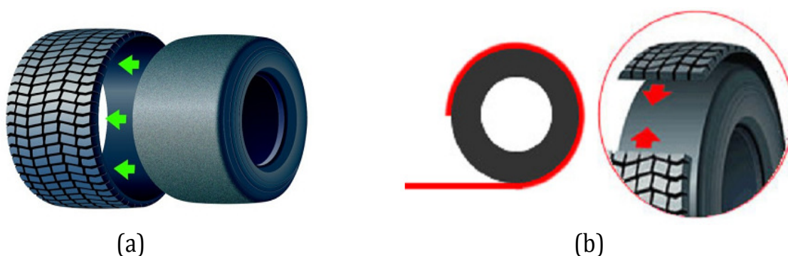
Slika 3.2.3 Varijante protekta - (a) u obliku prstena, - (b) u obliku trake
