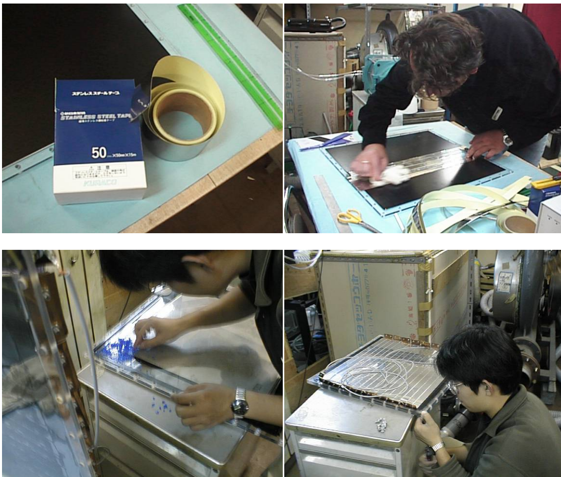
Slika 4-32 Postupak izrade test sekcije udarne ploče sa tečnim kristalima
