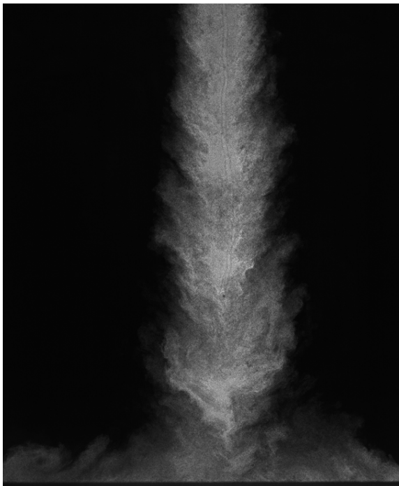
Slika 5-51 Vizuelizacija udara o ravnu podlogu- bez zvuka; Re=91000 ; L/D=8
