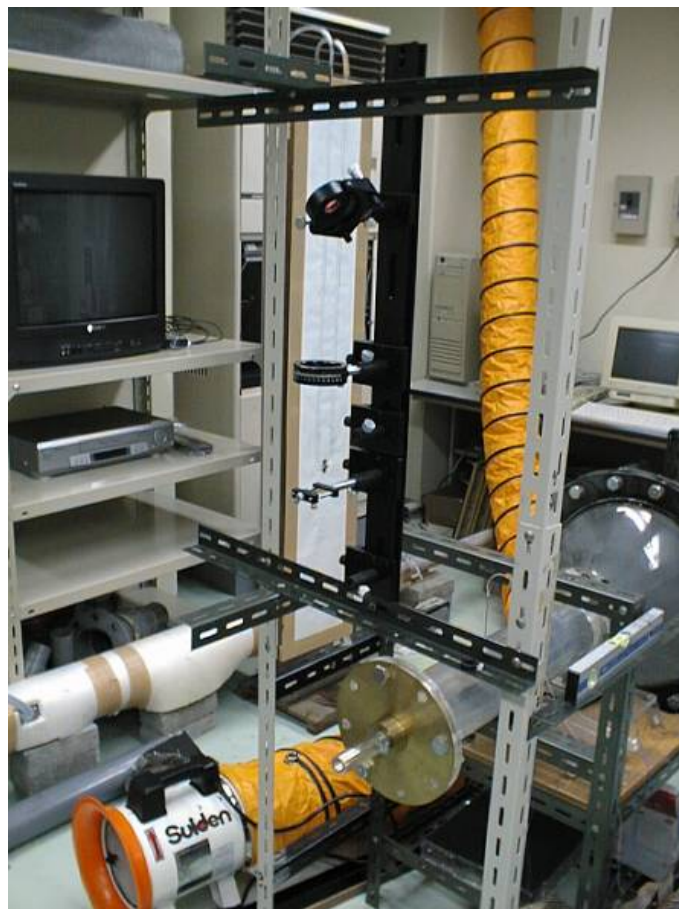
Slika 4-30 Optički set za kontrolu laserskog polja
