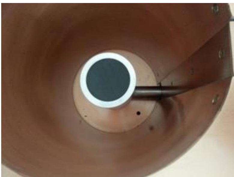
Сл. 8.2 Унутрашњост система. Канберин GX5020 коаксијални детектор окружен је оловном заштитом
