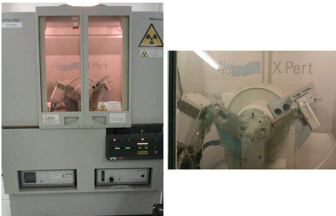
Slika 11. Fotografija instrumenta PANalytical X'Pert 3 Powder (levo) i fotografija goniometra sa X'Celerator detektorom (desno).
