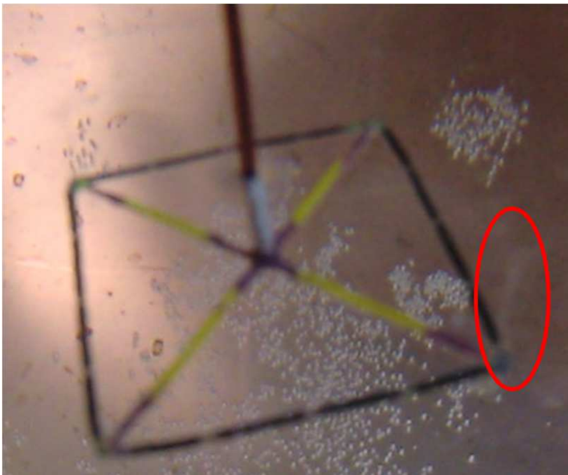
Сл. 7.10 – Модел ME11 урођен у воду током експеримента (беличаст вертикалан стуб уоквирен црвеном елипсом садржи покретне мехуриће)
