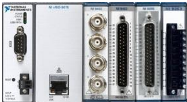
Сл. 3.4 CRIO-9075 платформа са NI C серијом I/O модула
