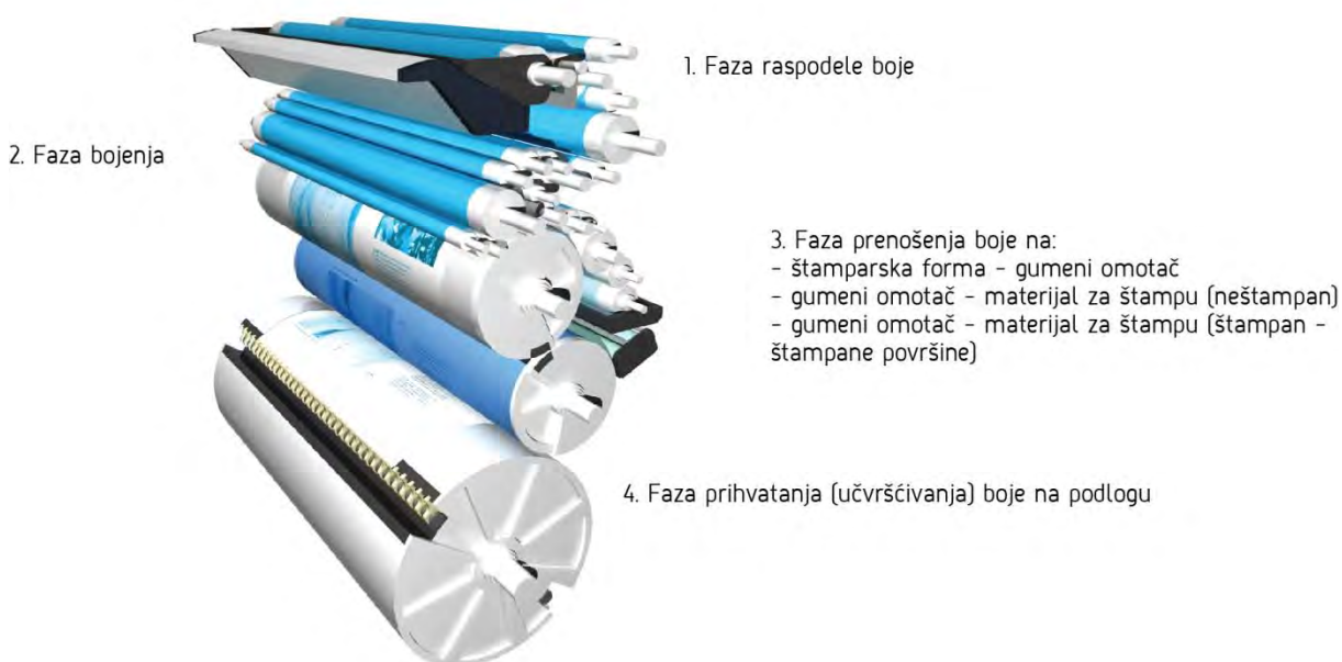
Slika 2.8 Faze prenosa boje u putanji kretanja boje jedinice za boju
