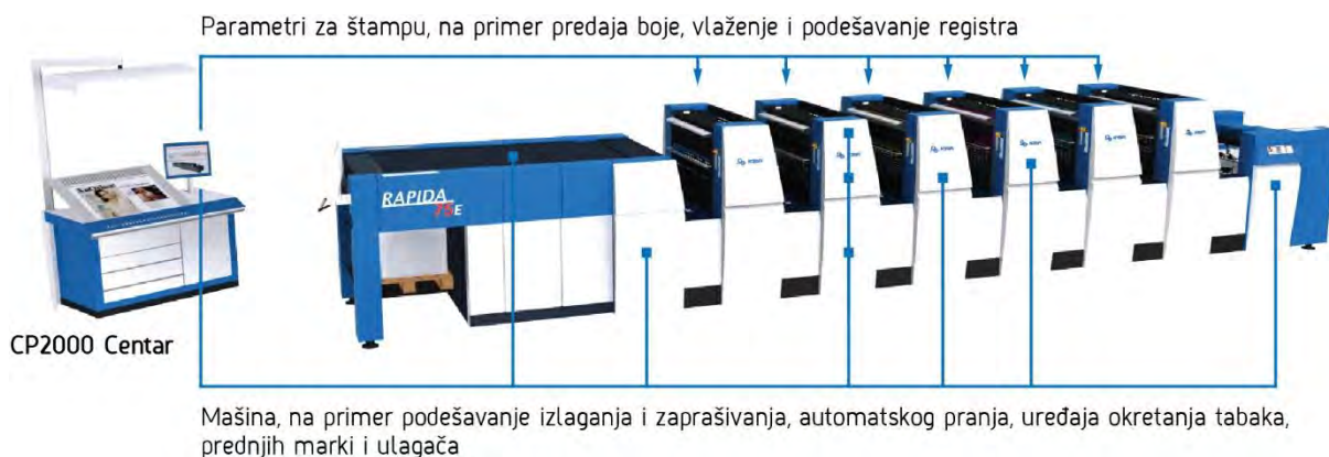
Slika 2.18 Upravljačke funkcije jedne tabačne ofset mašine
