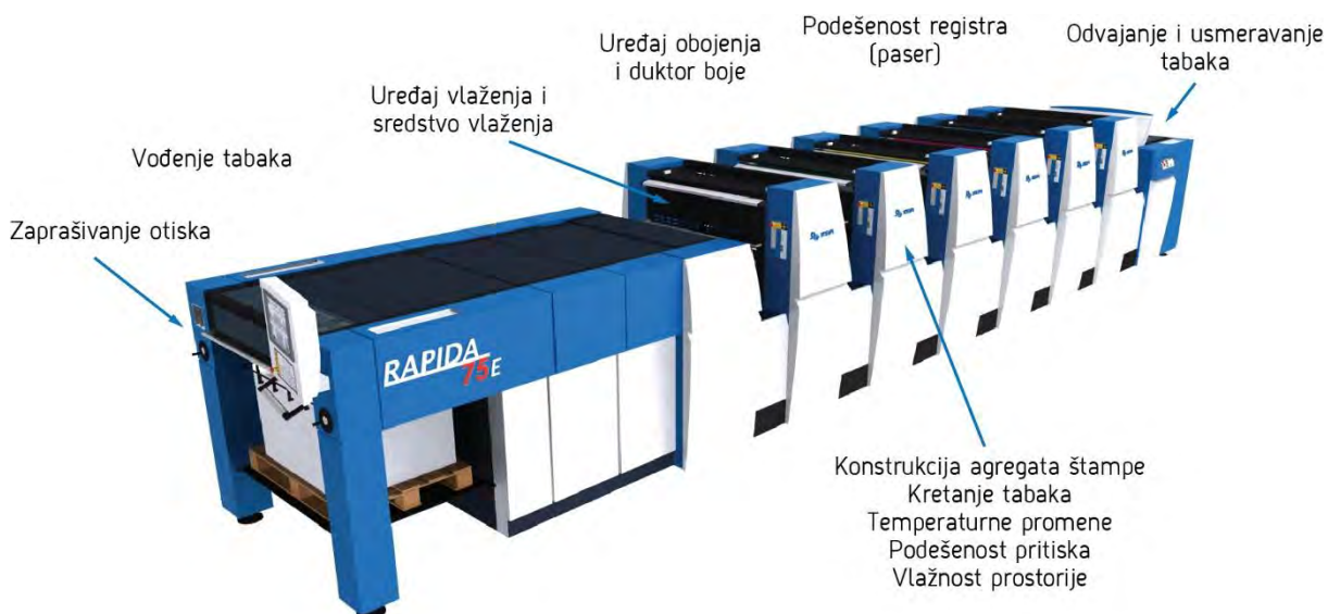
Slika 2.12. Uticaji na proces štampe jedne štamparske mašine
